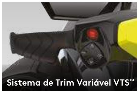
Fornecer configurações rápidas ativadas no guidão, para que o piloto possa encontrar o nivelamento ideal, seja quais forem as condições da água.
